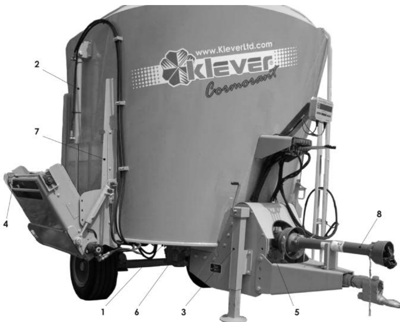
Рис. 18 Объекты смазки миксера
