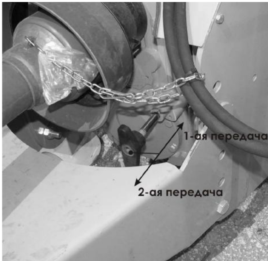
Рисунок 12 Переключение передач на двухступенчатом редукторе
