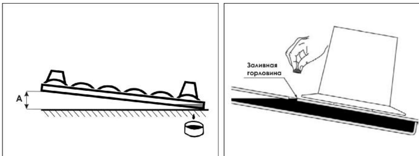
Рисунок 15 Проверка уровня масла в режущем бруссе
