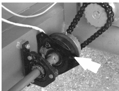
Рисунок 2.13. Муфта привода вала дозатора
