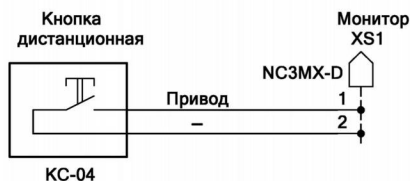
Кабель № 1 Провод ПВС 2 х 0,75 1 м
