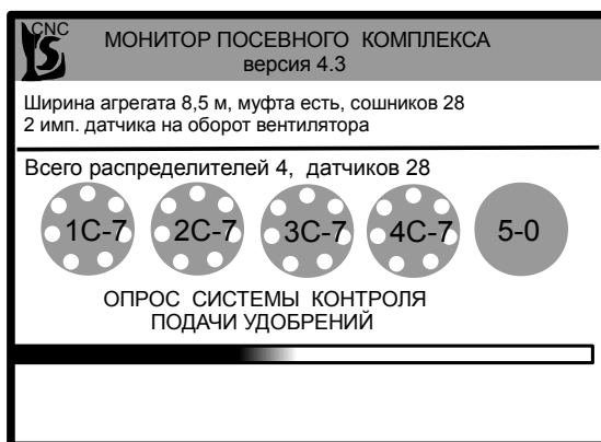
Рисунок 4.5. Конфигурация системы контроля высева семян
