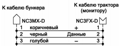
Кабель № 3 Провод ПВС 3 х 1,5 12 м
