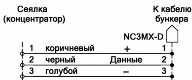
Кабель № 4-2 Провод ПВС 3 х 1,5 7 м
