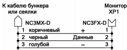
Кабель № 2 Провод ПВС 3 х 1,5 8 м
