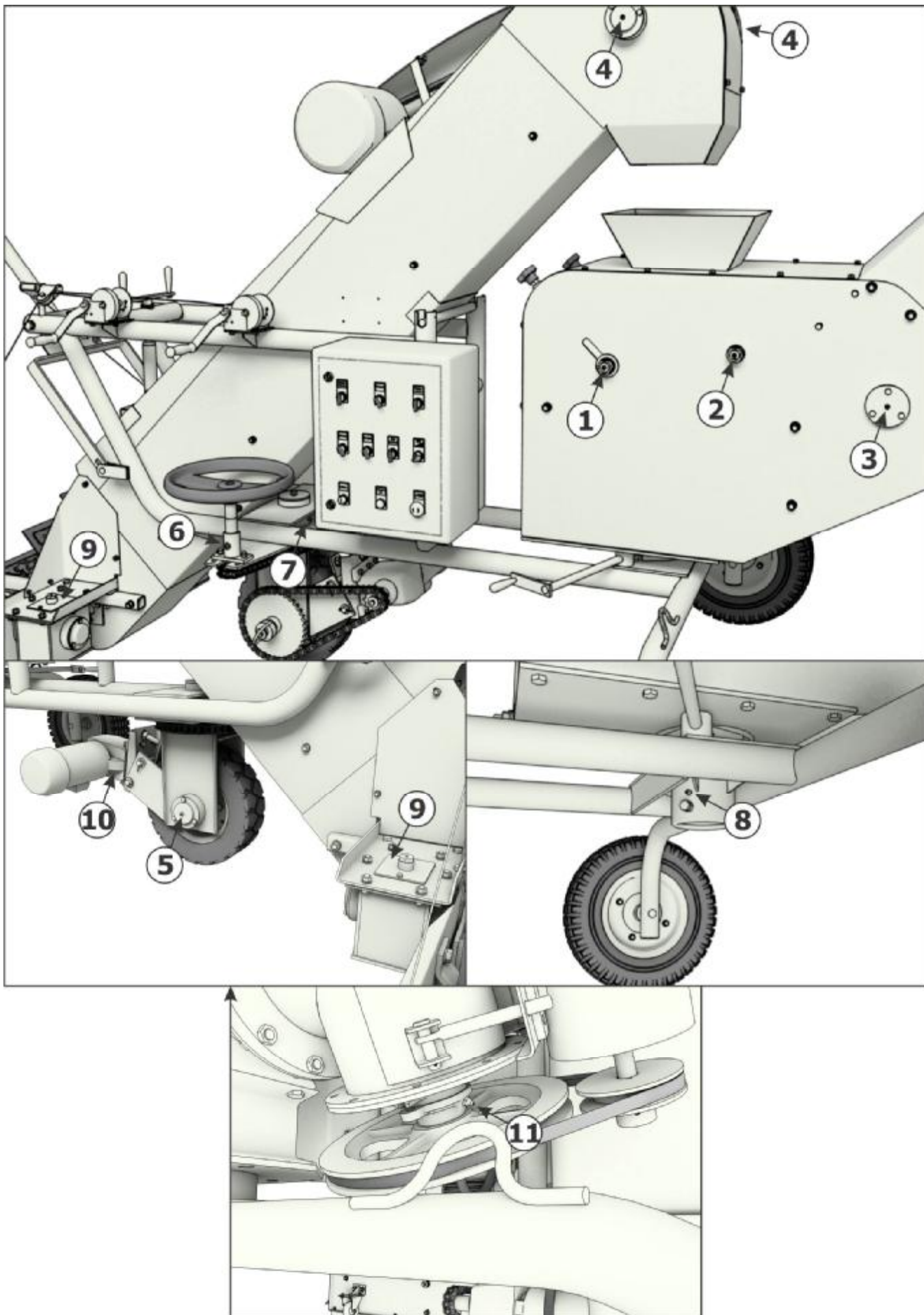
Рис. 24 Объекты и точки смазки комплекса
