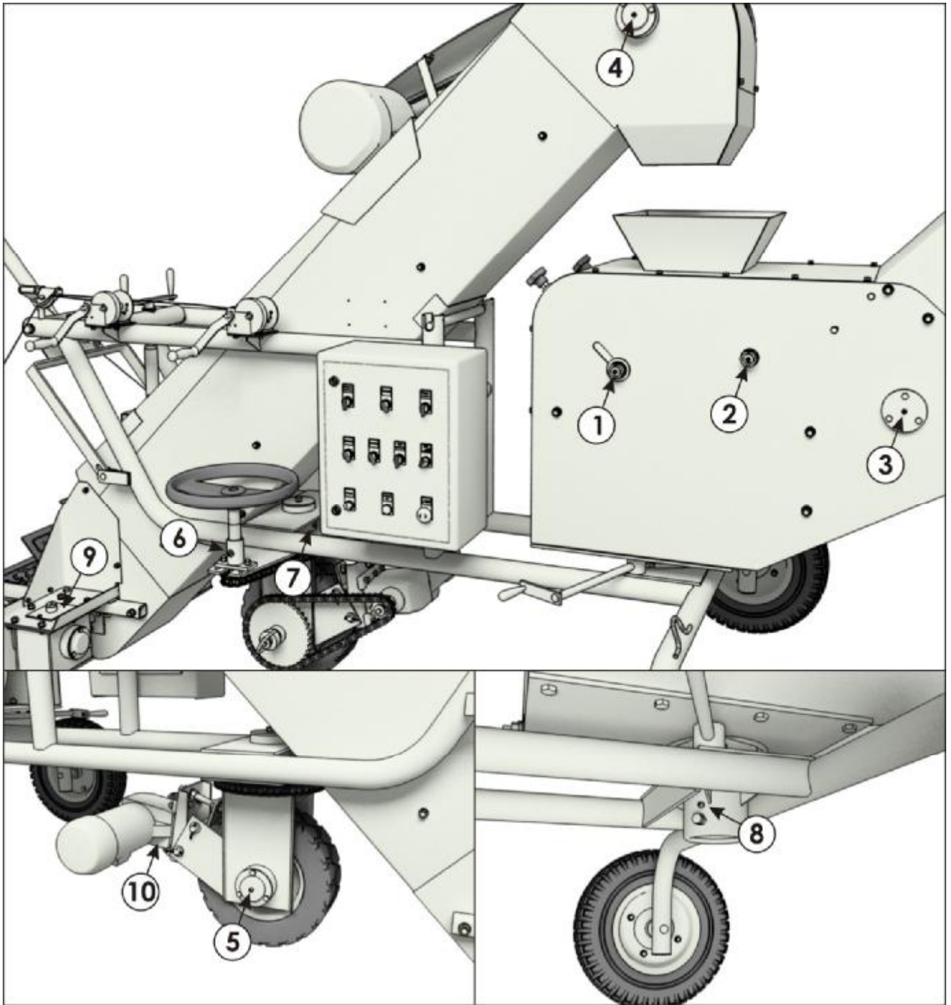
Рисунок 20 Объекты и точки смазки зерномета
