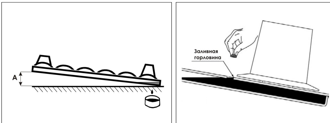
Рисунок 8.2 - Проверка уровня масла в режущем брус
